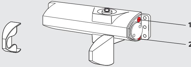
A velocidade de fecho do TS 90 Impulse é continuamente ajustável por meio de válvulas em duas gamas independentes.
