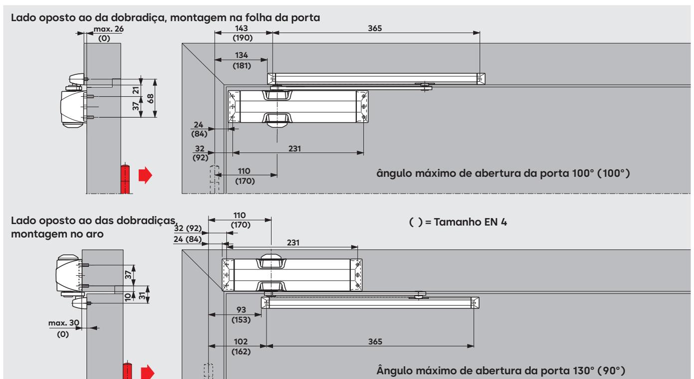
Dependendo das condições estruturais, é provável que o ângulo de abertura da porta seja limitado a cerca de 95°. Recomenda-se a instalação de batente amortecido ou a colocação de um batente de porta neste ponto. Como a abertura da porta está limitada a 95°, o TS90 não tem a marca CE no lado de empurrar da porta. A norma BS EN1154 exige um fecho mínimo de 105°.
