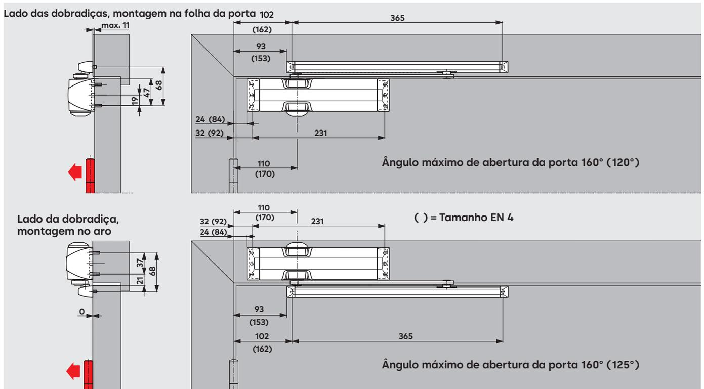
Dependendo das condições estruturais, o ângulo de abertura da porta é limitado. Recomenda-se a utilização da limitação de abertura ou a utilização de um batente de porta. Para as portas corta-fogo e corta-fumo, deve ser instalado um batente.
